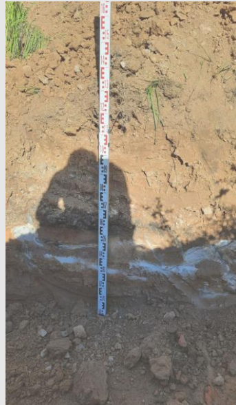
Baggerschurf im Bereich des ehem. Gleisanschlusses mit Streifenfundamenten
