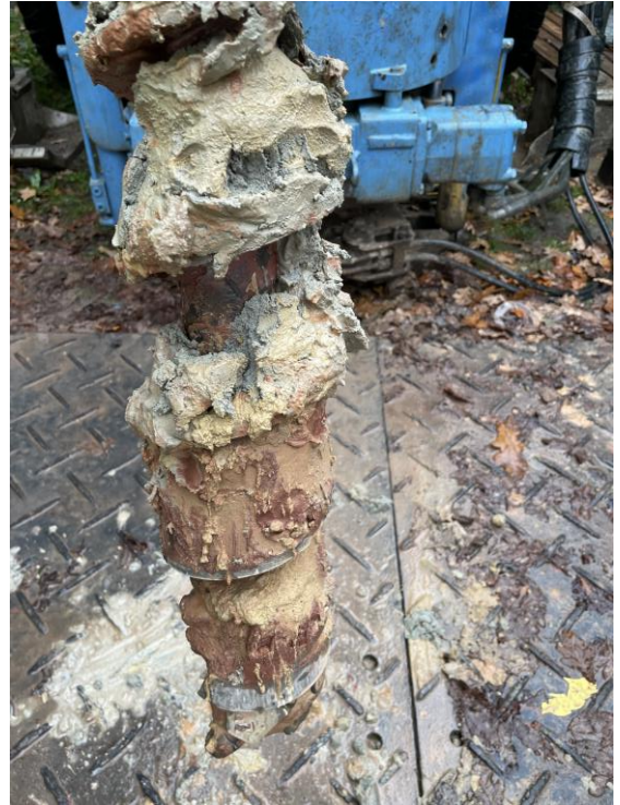
GWM 112, Übergang Solling-Formation (grauer Sand, durchlässig) in Hardeggen-Formation (rotbrauner Ton, gering durchlässig)
