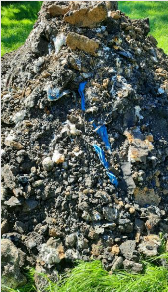
Baggerschurf mit ausgehobener Auffüllung auf der ehem. Betriebsdeponie
