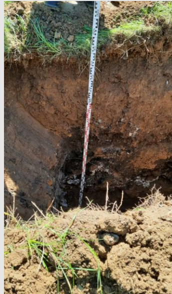
Baggerschurf mit ausgehobener Auffüllung auf der ehem. Betriebsdeponie
