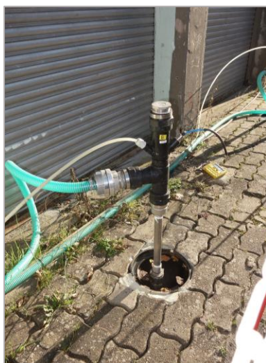
Bodenluftabsauganlage und Bodenluftpegel mit paralleler Wasserfassung (Stand 2023)
